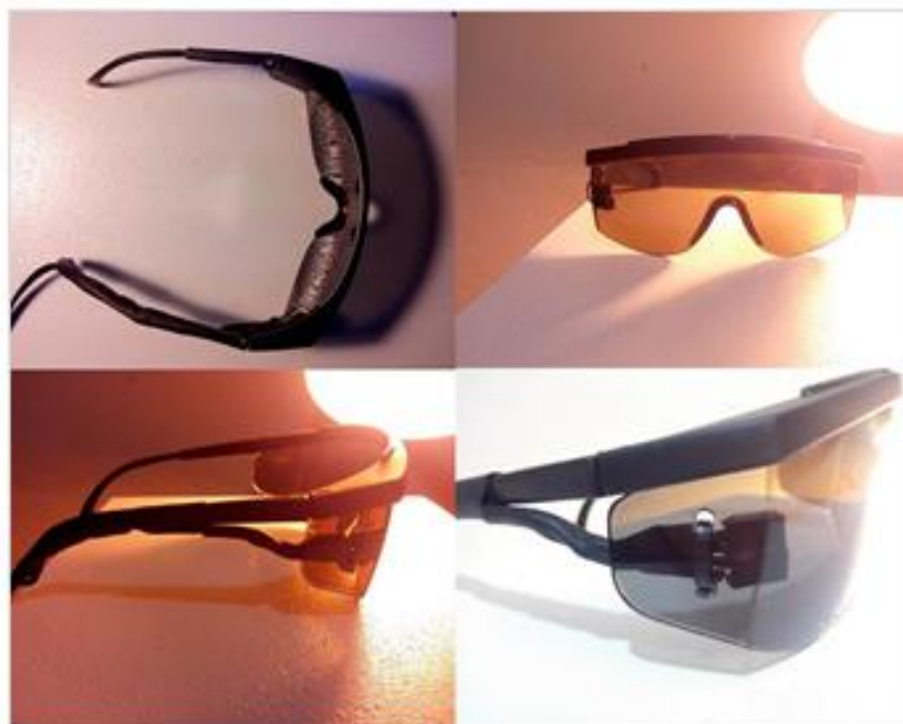
Figura 29: Imágenes del prototipo del lente utilizado para las pruebas. El sensor como se puede observar se instaló a la derecha del mismo.
